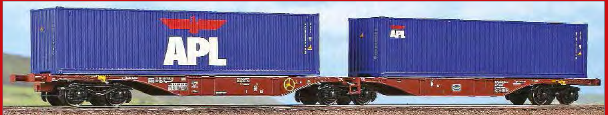
Carro intermodale Tipo Sggmrss 90 bimodulo Touax con carico di container. Container wagon Type Sggmrss 90 Touax loaded with containers. Containerwagen Typ Sggmrss 90 Doppelmodul der Touax, mit Containern.
