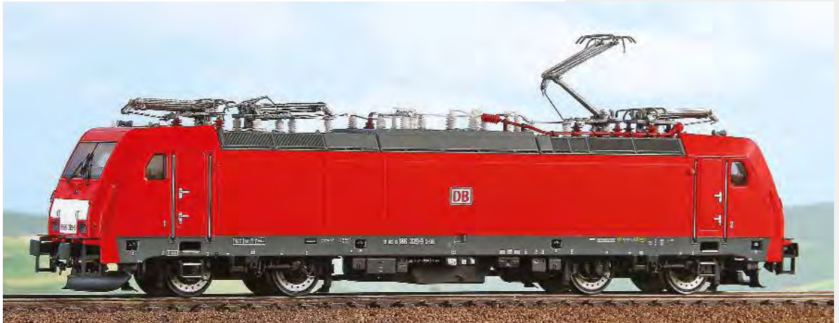
Locomotiva politensione E 186 329 di DB Schenker per i treni internazionali tra Belgio, Germania, Francia. Multi System E 186 329 DB Schenker used for goods trains between Belgium, Germany and France. E-lok E 186 329 der DB Schenker für internationale Güterzüge zwischen Belgien, Deutschland und Frankreich.
