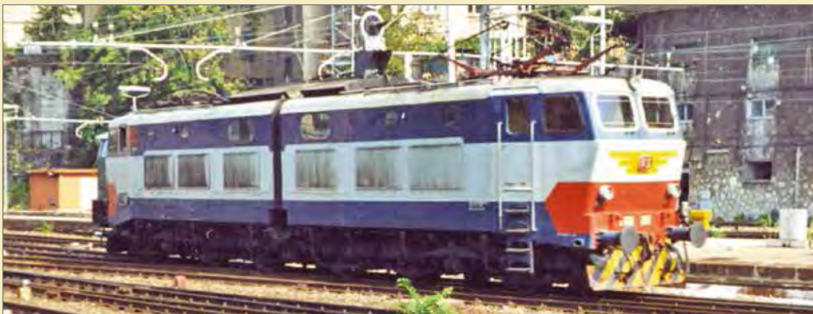
Locomotiva articolata delle FS E.656.204 (seconda serie). Livrea di origine, pantografi Tipo FS 52, respingenti tondi. E.656.204 Italian Railways locomotive (second series). Original livery, Type 52 pantographs, round buffers. E-Lok E.656.204 der italienischen Eisenbahnen (zweite Bauserie). Originallackierung, Typ 52 Stromabnehmer, runde Puffer.
