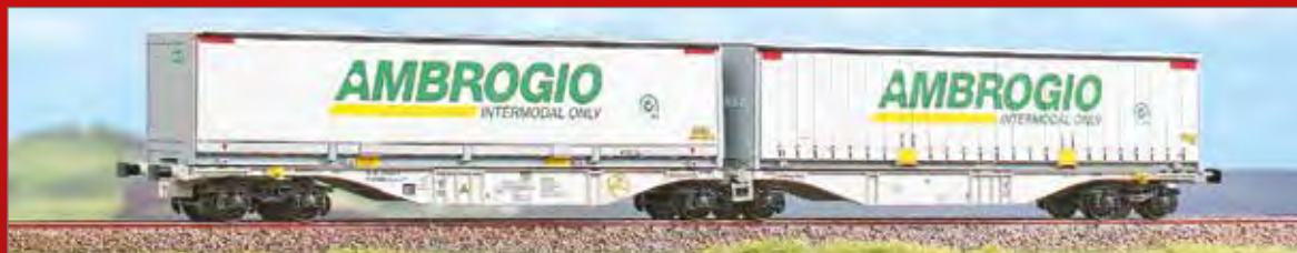
Carro intermodale Tipo Sggmrss '90 bimodulo AAE noleggiato IMT ed in uso ad Ambrogio con due casse mobili "Ambrogio" Container wagon Type Sggmrss '90 AAE hired to IMT and used by Ambrogio with two swap bodies Containerwagen Typ Sggmrss '90 Doppelmodul der AAE vermietet an IMT, genutzt von Ambrogio mit zwei Wechselpritschen
