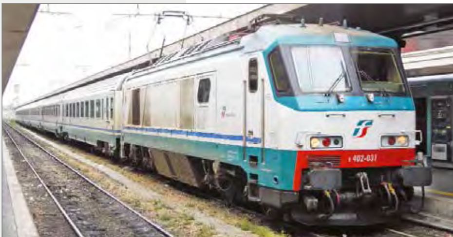
Locomotiva elettrica E.402.031 di Trenitalia, in livrea XMPR con connettori per il comando per le porte del treno. Electric locomotive E.402.031 of Trenitalia, in XMPR livery with sockets for independent side control of the train doors. Lokomotive E.402.031 der Trenitalia, in XMPR Lackierung, mit Steckdosen zur Türfernbedienung des Zuges.
