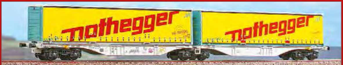
Carro intermodale Tipo Sggmrss '90 bimodulo AAE noleggiato a LOTRAS caricato con due casse mobili "Nothegger" Container wagon Type Sggmrss '90 AAE hired to LOTRAS with two "Nothegger" swap bodies Containerwagen Typ Sggmrss '90 Doppelmodul der AAE vermietet an LOTRAS mit "Nothegger" Wechselpritschen
