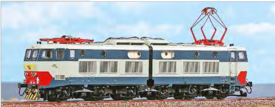
Locomotiva articolata delle FS E.656.569 (sesta serie). Livrea di origine, pantografi Tipo FS 52, respingenti rettangolari. E.656.569 Italian Railways locomotive (sixt series). Original livery, Type 52 pantographs, squared buffers. E-Lok E.656.569 der italienischen Eisenbahnen (sechste Bauserie). Originallackierung, Typ 52 Stromabnehmer, rechteckige Puffer.
