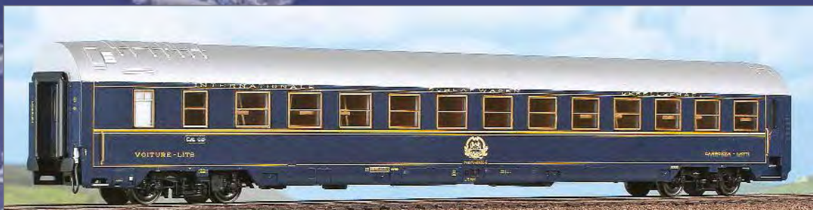
Carrozza letti Tipo MU 1964 in livrea di origine con marcatura unificata, immatricolata presso le DB. Type MU 1964 sleeping car, original livery with unified road number, registered at DB. Typ MU 1964 Schlafwagen, Originallackierung mit UIC-Nummer, bei der DB eingestellt.
