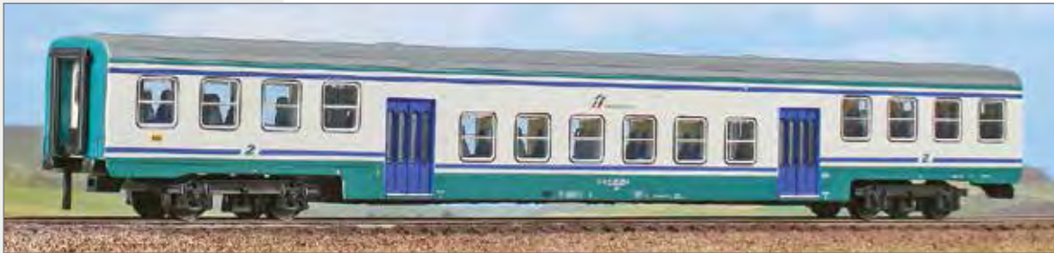
Carrozza FS a piano ribassato (serie 1973) di 2ª classe in livrea XMPR con arredo moderno. Low-level 2 nd class regional car (1973 series), XMPR livery, modern interior.
