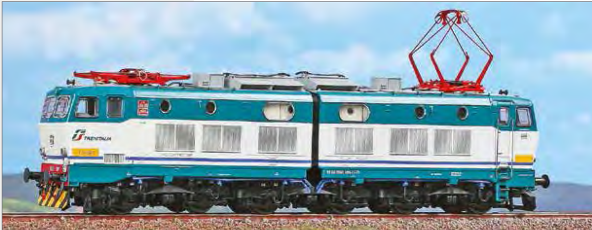
Locomotiva articolata delle FS E.655.089 (prima serie). Livrea XMPR, pantografi Tipo FS 52, respingenti tondi. E.655.089 Italian Railways locomotive (first series). XMPR livery, Type 52 pantographs, round buffers. E-Lok E.655.089 der italienischen Eisenbahnen (erste Bauserie). XMPR Lackierung, Typ 52 Stromabnehmer, runde Puffer.
