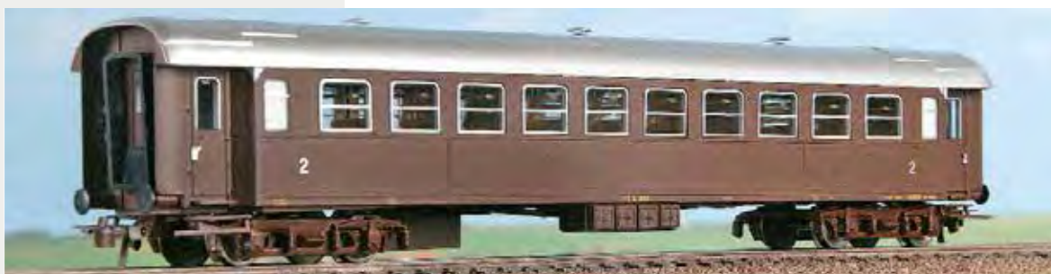
Carrozza FS di 2ª classe Tipo 1956R (Bz 30800), livrea castano di origine. 2 nd class Type 1956R (Bz 30800) car of the FS. Type FS ABM bogies, Type Klein windows, brown livery. 2. Klasse Wagen Typ 1956R (Bz 30800) der FS, Typ FS ABM Drehgestelle, Typ Klein Übersetzfenster, braune Ursprungslackierung.
