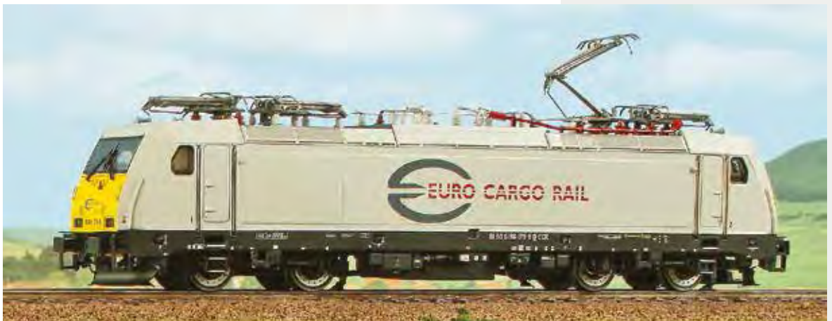
Locomotiva politensione E 186 179 Euro Cargo Rail per i treni internazionali tra Belgio, Germania, Francia. Multi System E 186 179 Euro Cargo Rail used for goods trains between Belgium, Germany and France. E-lok E 186 179 der Euro Cargo Rail für internationale Güterzüge zwischen Belgien, Deutschland und Frankreich.
