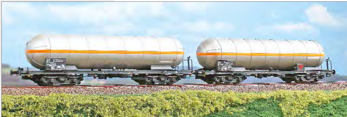
Coppia di carri cisterna Zagkk immatricolati presso le FS dalla società Ultragas. Set of two Italian Railways Zagkk tank wagons, owned by Ultragas Set aus zwei Tankwagen Zagkk, der Gesellschaft Ultragas, bei der FS eingestellt.
