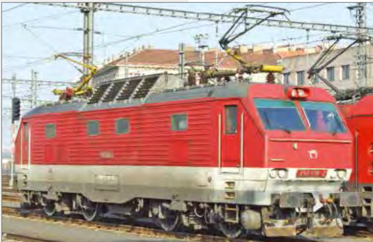
Locomotiva polintensione Classe 350 delle Ferrovie Slovacche ZSSK per servizi internazionali, stato attuale. Class 350 locomotive of the ZSSK (Slovakian Railways) for international services, actual status. E-Lok Baureihe 350 der ZSSK (Slowakische Eisenbahnen) für internationale Dienstleistungen, aktueller Zustand
