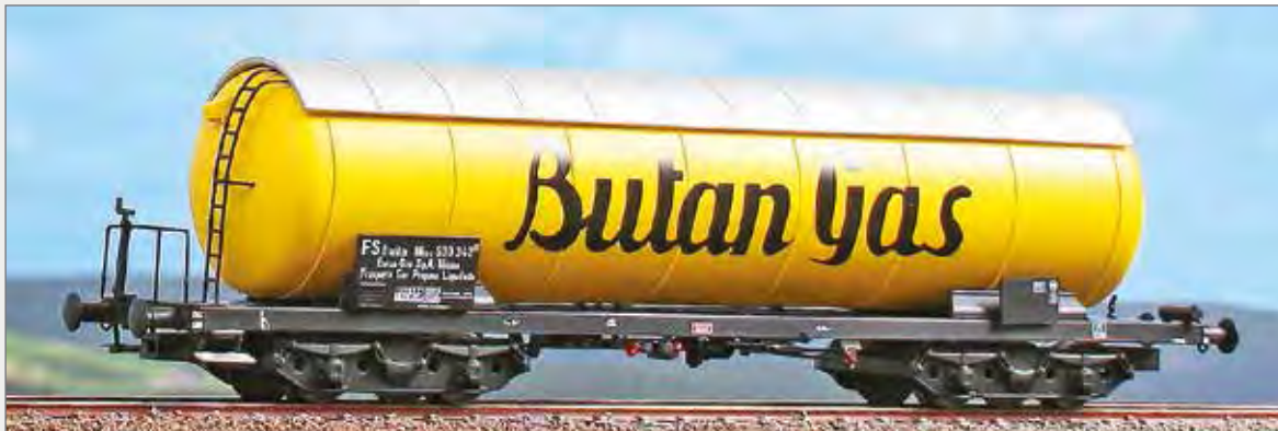
Carro cisterna Mbpz immatricolato presso le FS dalla società Butan Gas. Italian Railways Mbpz tank wagon, owned by Butan Gas. Tankwagen Mbpz, der Gesellschaft Butan Gas, bei der FS eingestellt.
