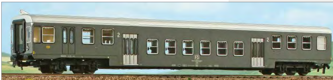
Carrozza pilota FS a piano ribassato (serie 1973) di 2 a classe in livrea grigio. Luci anteriori funzionanti secondo il senso di marcia. Low-level regional 2 nd class control car (1973) of the Italian Railways, slate gray livery. Headlights alternating with direction of travel. 2. Klasse Niederflur-Steuerwagen (1973) der italienischen Eisenbahnen, schiefergraue Lackierung. Scheinwerfer Fahrtrichtungsabhängig geschaltet.
