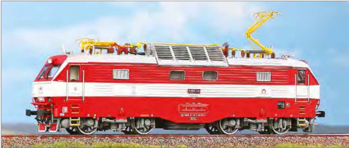
Locomotiva polintensione Classe 350 delle Ferrovie Slovacche ZSSK per servizi internazionali. Class 350 locomotive of the ZSSK (Slovakian Railways) for international services. E-Lok Baureihe 350 der ZSSK (Slowakische Eisenbahnen) für internationale Dienstleistungen.
