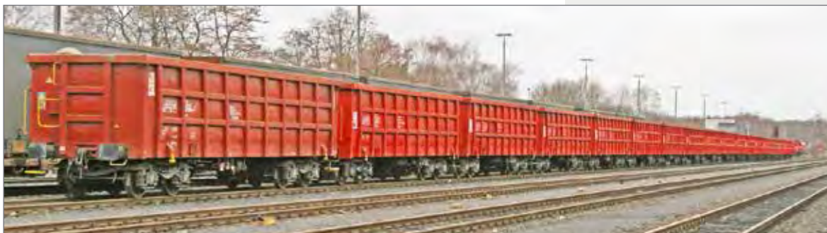
Set di tre carri Eaos ricostruiti della società tedesca HGK. Set of three reconstructed Eaos wagons of german company HGK. Set aus drei rekonstruierten Eaos Güterwagen der deutschen HGK.
