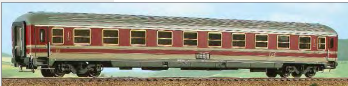
Carrozza di 1ª classe Tipo X 1982 delle FS, livrea beige e rosso fegato. Tetto cannellato, griglia in posizione centrale. 1 st class Type X 1982 car of the Italian Railways, beige and deep red livery. Ribbed roof, central side grill. 1. Klasse Typ X 1982 Wagen der italienischen Eisenbahnen, beige-leberrote Lackierung, gesicktes Dach, mittlere Lüftungsöffnung.
