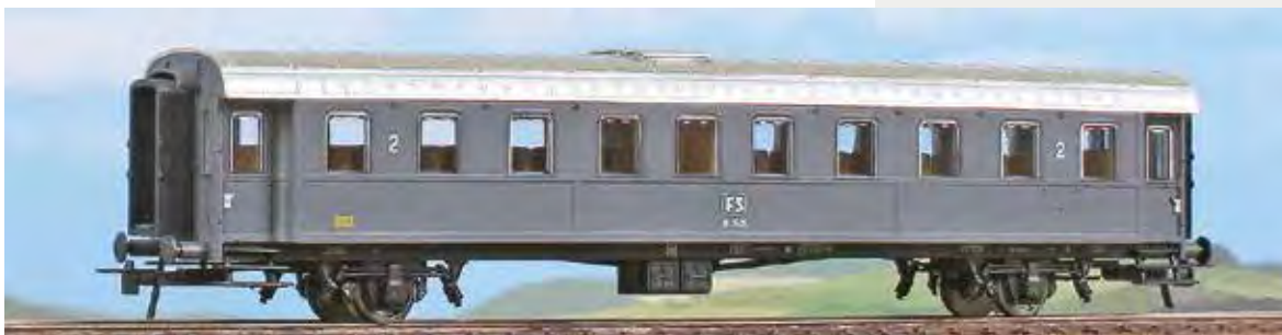
Carrozza FS di 2ª classe Tipo 1936 (BI 35000), sospensioni a doppia balestra, livrea grigio ardesia. Type 1936 Italian Railways 2 nd class car (BI 35000), double leaf spring, slate gray livery. 2. Klasse Wagen BI 35000-Serie (Typ 1936) der FS, zwei Achsen, mit Doppelfederung, schiefergraue Lackierung.
