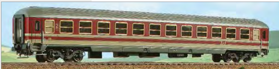
Carrozza di 2ª classe Tipo X 1982 delle FS, livrea beige e rosso fegato. Tetto cannellato, griglia in posizione centrale. 2 nd class Type X 1982 car of the Italian Railways, beige and deep red livery. Ribbed roof, central side grill. 2. Klasse Typ X 1982 Wagen der italienischen Eisenbahnen, beige-leberrote Lackierung, gesicktes Dach, mittlere Lüftungsöffnung.
