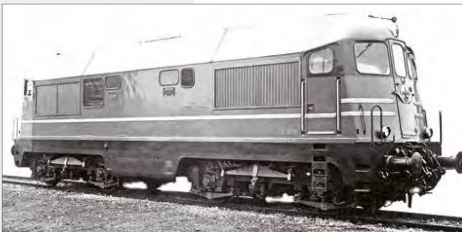
Locomotiva FS D.342.4015 sovralimentata, livrea rosso, castano e Isabella. Italian Railways Diesel locomotive D.342.4015 turbocharged, red and two tone brown livery. Italienische Diesellokomotive D.342.4015 mit Turbolader, rote und zweitönige braune Farbgebung.
